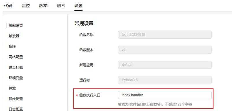
**步骤4** 在“代码”页签，请根据设置的函数执行入口修改对应的文件名和执行函数名，如图 5-5所示。
