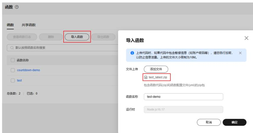
3. 系统将自动读取和配置函数的运行时，自定义编辑函数名称后单击“确定”，完成函数导入。
