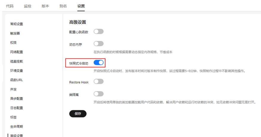
4. (可选) 如果函数强依赖于有状态, 还需配置Restore Hook进行状态刷新, 并在函数代码中实现对应的Hook逻辑。
